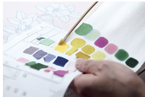
使用する色は染料を混ぜて1色ずつ生成する。デザイナーから受け取った配色見本と見比べながら色を決める
