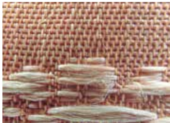
(Fig. 22-2) [二階織物] 経 3 枚綾地 / 浮織
