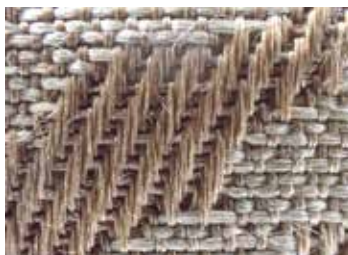
(Fig. 15-2) Z 経 6 枚綾地／S 緯 3 枚綾文 地絡み
