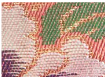
(Fig. 14-2) Z 経 6 枚綾地／Z 緯 3 枚綾文 地絡み
