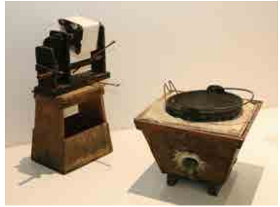
(図8)(左)上州式座繰り器(右)繰糸鍋(岡谷蚕糸博物館所蔵)
