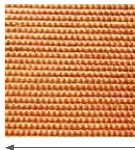
(図6-1、2) 【織組織】平織 ※矢印は経糸の向きを示す
